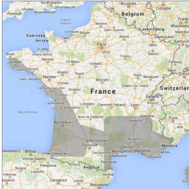
**Figure 14 : Carte des zones d'émission des applications de télémessures la bande 2,3 GHz pouvant potentiellement causer des brouillages sur les réseaux mobiles**
